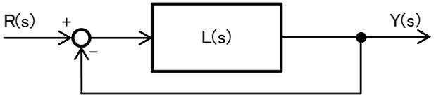
(図11)閉ループ系(フィードバック系)
